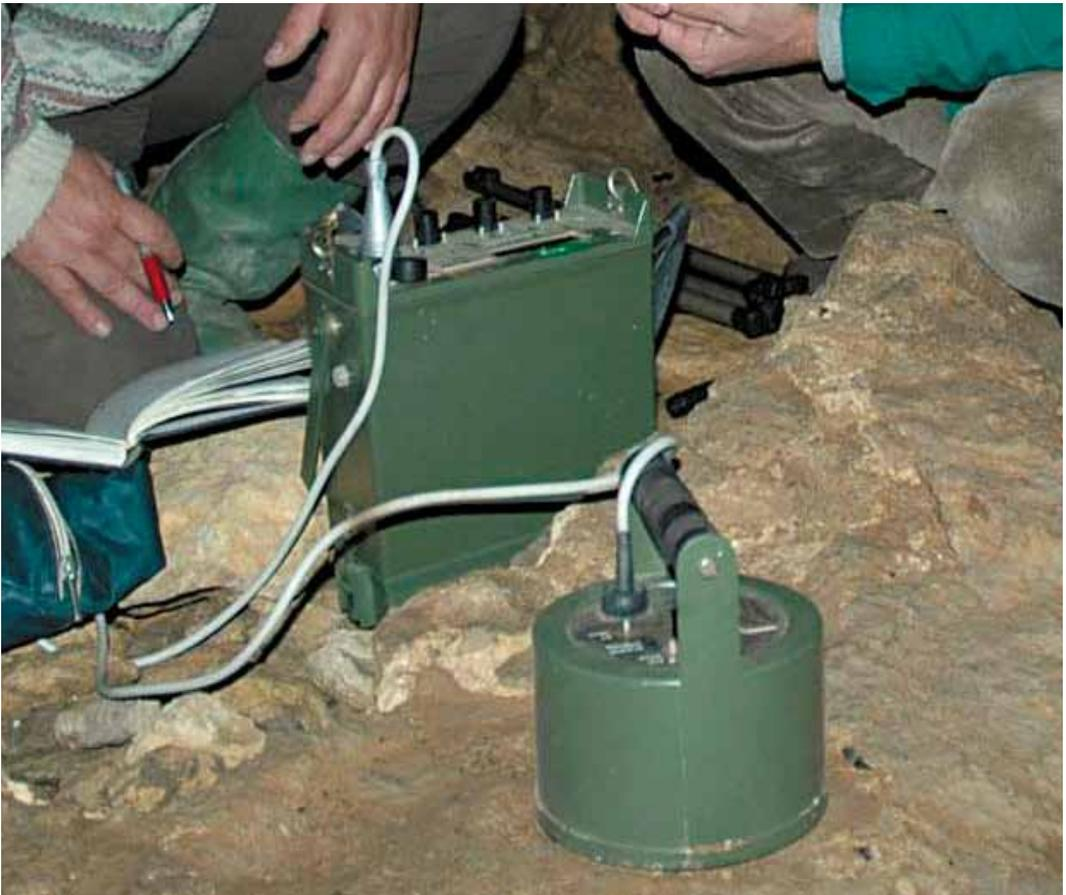
Fig. 12 - Strumento di misura utilizzato per radiazioni alfa-beta-gamma in materiali solidi.
