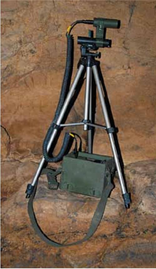
Fig. 10 - Strumento di misura utilizzato provvisto di sonda specifica per radiazioni beta/gamma in aria e di sonda alfa-sensibile a finestra di mica.
