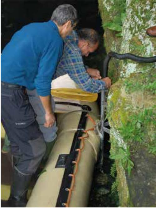
*Fig. 4 Posizionamento della sonda multiparametrica alla sorgente dell'Oliero: l'acquisitore posizionato all'esterno, con il terminale di download e le batterie di alimentazione*
