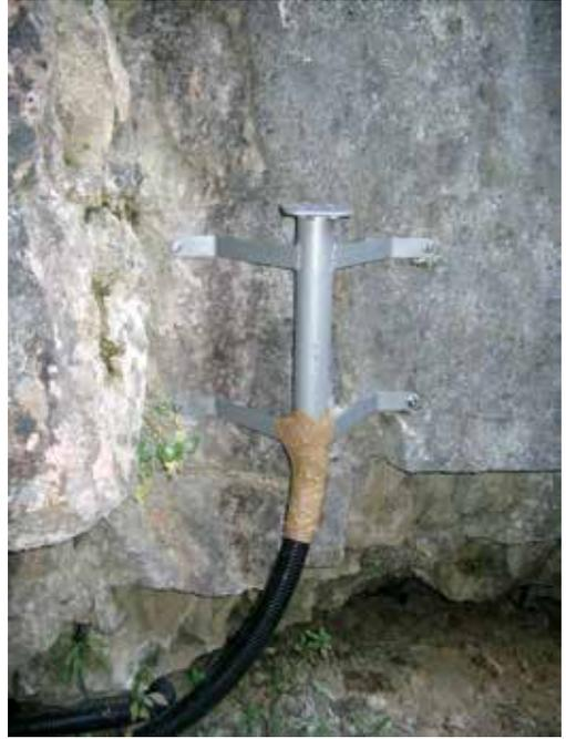
*Fig. 3 Posizionamento della sonda multiparametrica alla sorgente dell'Oliero: la parte della sonda immersa in acqua contenente i sensori*
