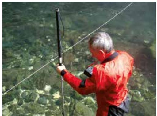
Fig. 6 Misure di portata mediante utilizzo di mulinello idrometrico ad elica
