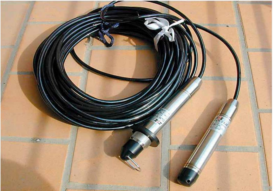
*Fig. 5 Sonda multiparametrica della ditta STS serie DL70 multi, foto A. Riva*
