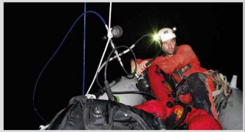
Le bombole sono state caricate tramite una manichetta alta pressione di 150 m di lunghezza, proveniente da un compressore in superficie, foto V. Berclaz
